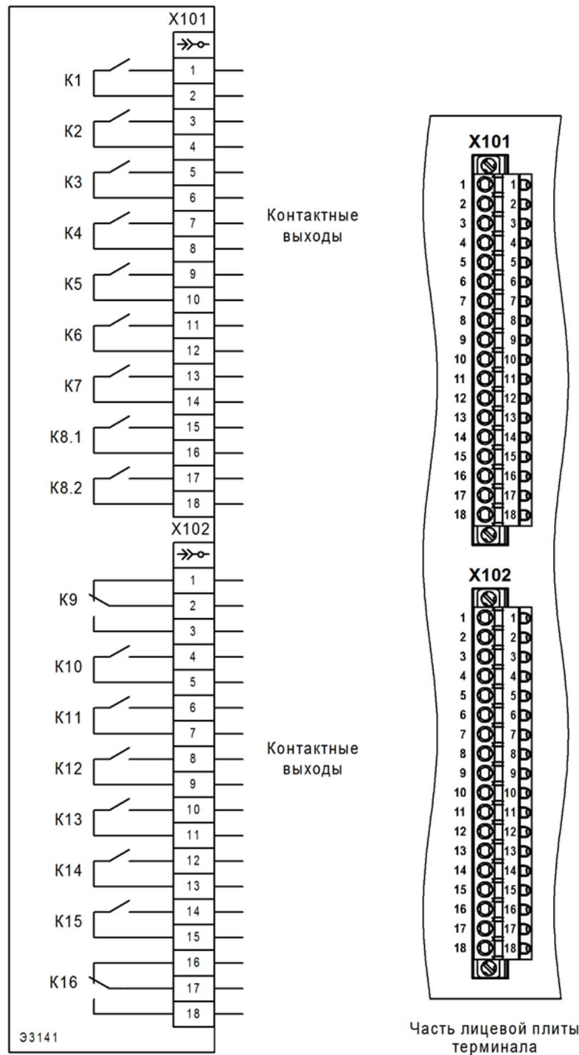
X101, X102 – разъем ФКС 2,5/18-STF-5,08 BD:1-18Q/3 №1187081 Phoenix Contact с технологией PUSH-IN штекерного подключения проводников
