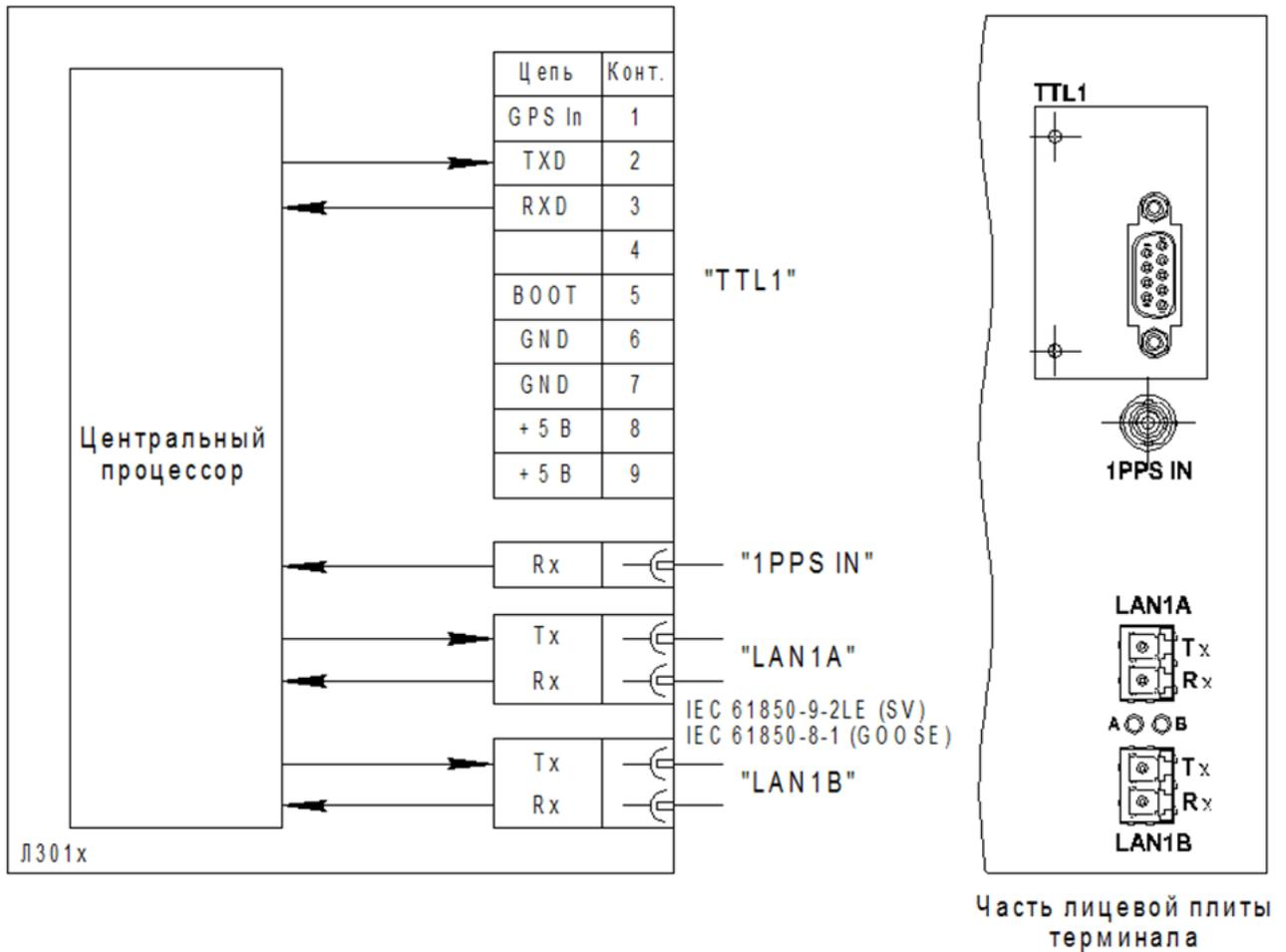
TTL1 – порт последовательной связи, разъем DB9-F;
