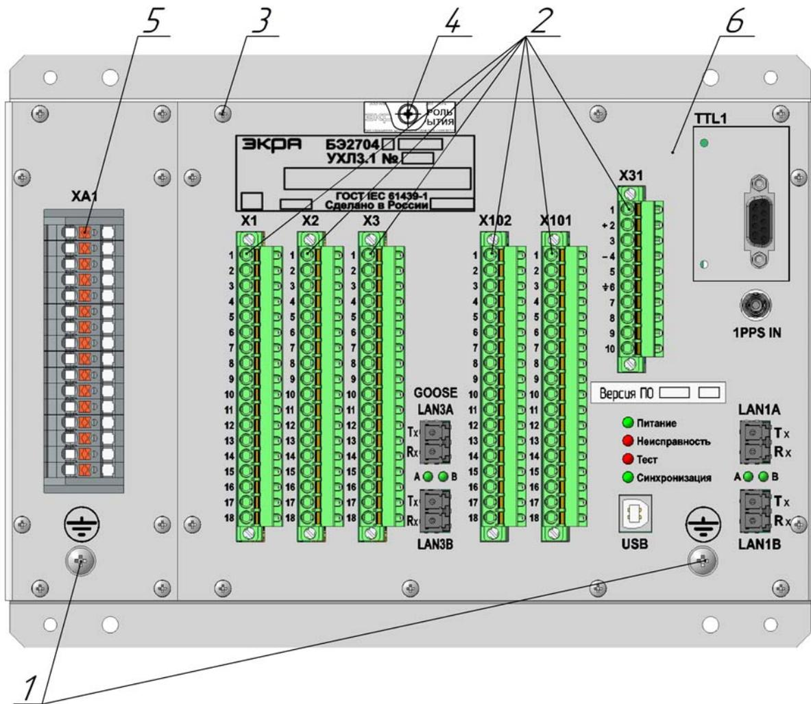
1 – винт заземления. Винт DIN 967 – M4×8 – 5.8 – Z (2 шт.);
