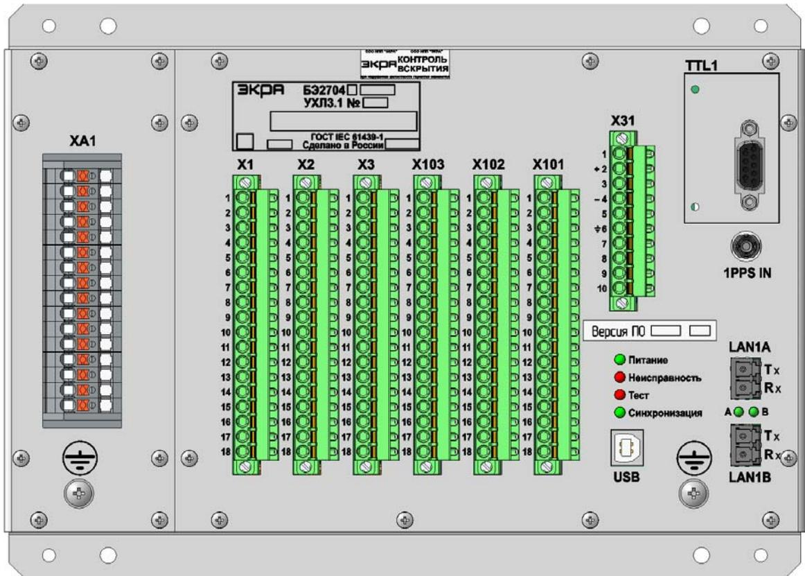
Рисунок Б.3 – Расположение элементов на лицевой плате терминалов БЭ2704 702008 – 702011
