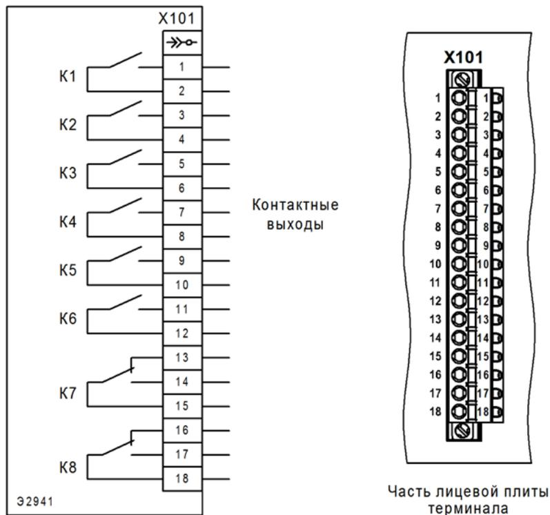
X101 – разъем FKC 2,5/18-STF-5,08 BD:1-18Q/3 №1187081 Phoenix Contact с технологией PUSH-IN штекерного подключения проводников
