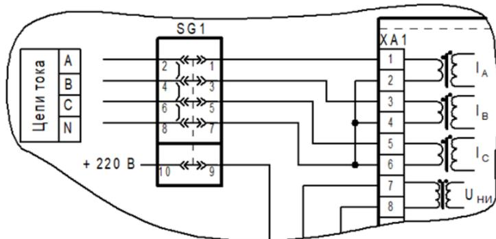
SG1 – блок испытательный
