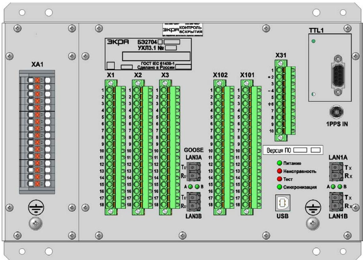
Рисунок Б.4 – Расположение элементов на лицевой плате терминалов БЭ2704 702012 – 702015
