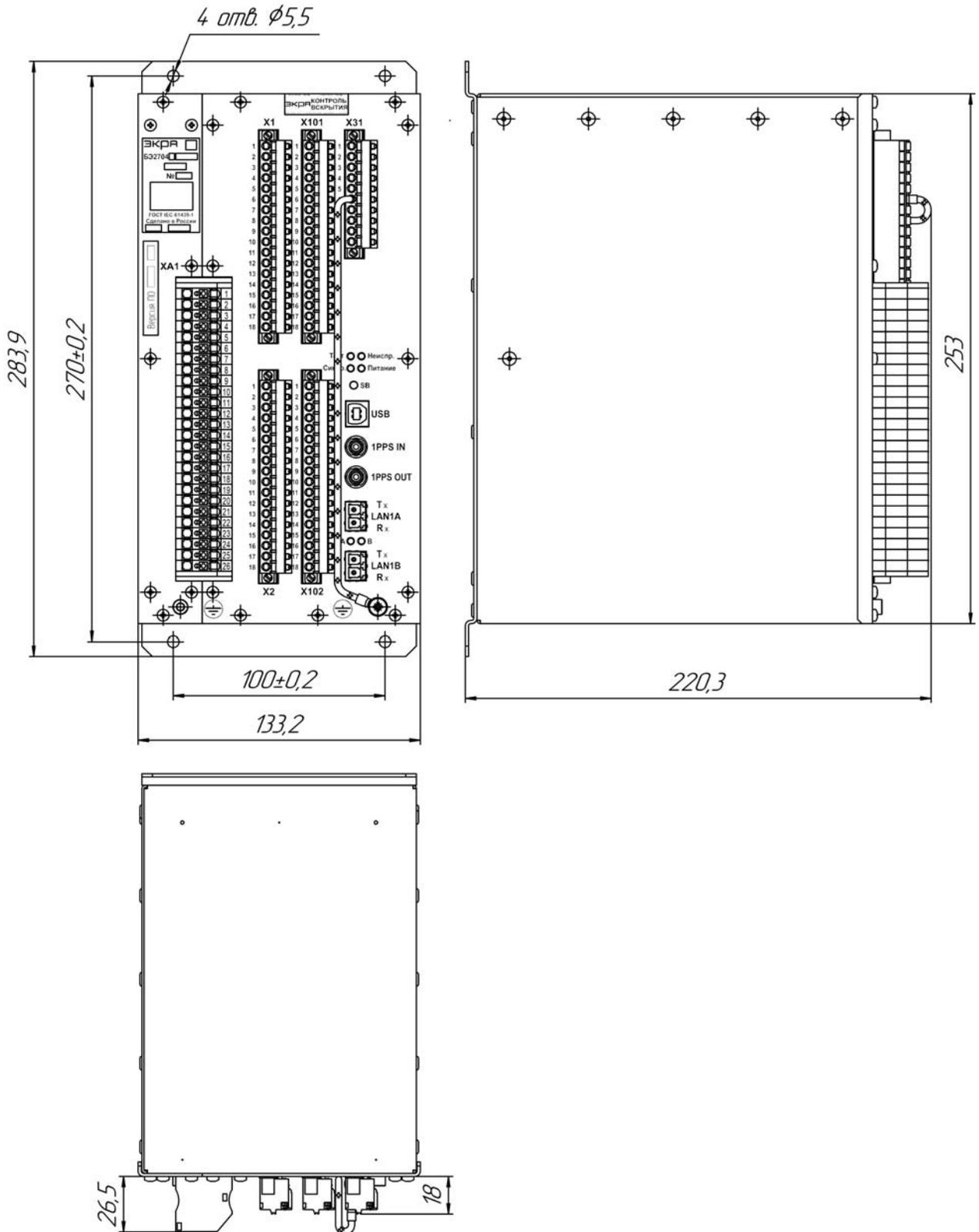
Размеры без предельных отклонений справочные, мм, не более. Масса терминала – не более 6 кг.
