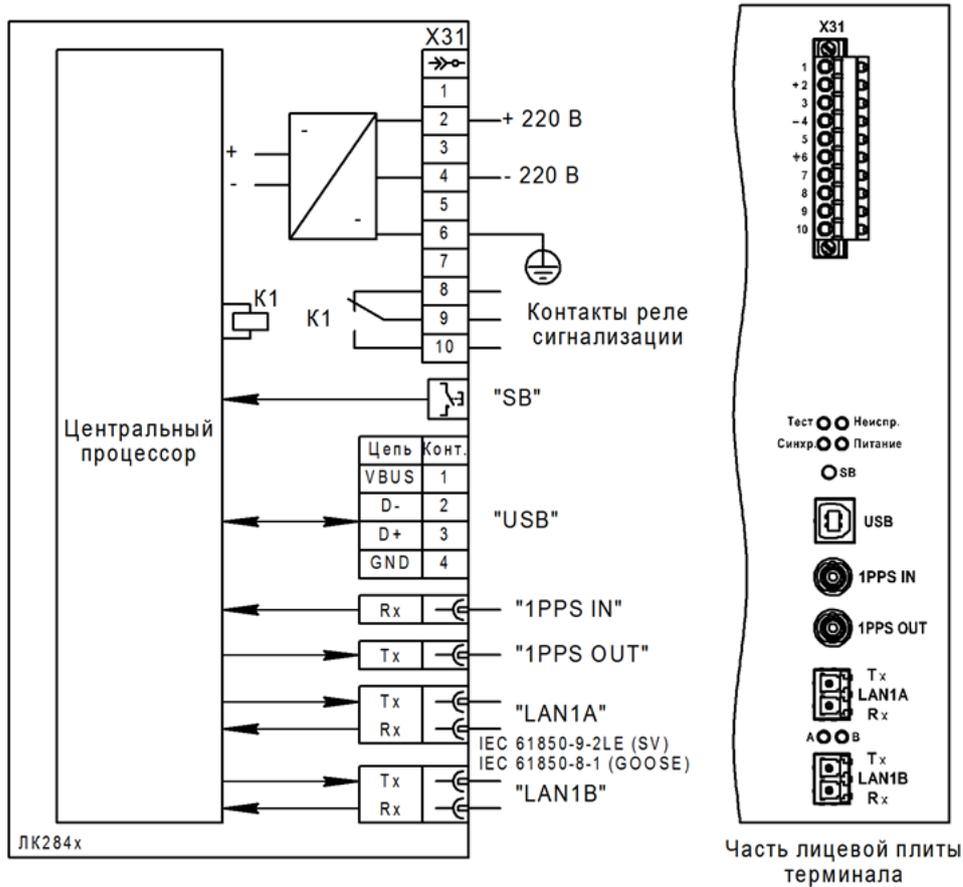
X31 – разъем FKC 2,5/10-STF-5,08 BD:1-10Q/3 №1187077 Phoenix Contact с технологией PUSH-IN штекерного подключения проводников;
