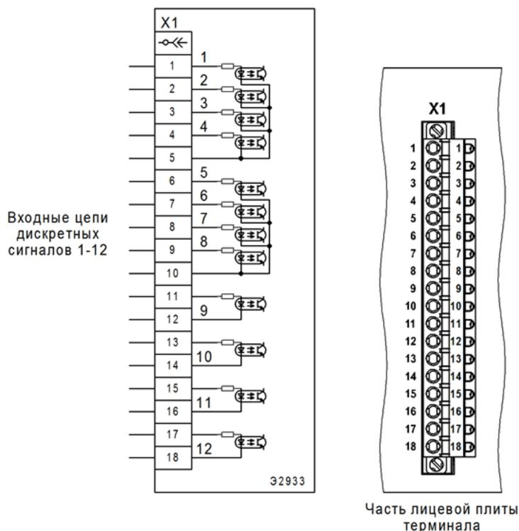
X1 – разъем FKC 2,5/18-STF-5,08 BD:1-18Q/3 №1187081 Phoenix Contact с технологией PUSH-IN штекерного подключения проводников
