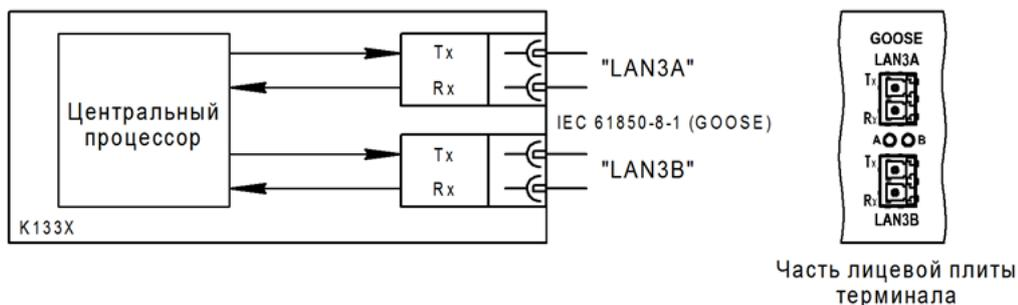
LAN3A, LAN3B – Ethernet-порты с интерфейсом связи 100BASE-FX (оптический), разъем типа LC. Возможно исполнение блока с интерфейсом связи 100BASE-TX (электрический), разъем типа RJ45
