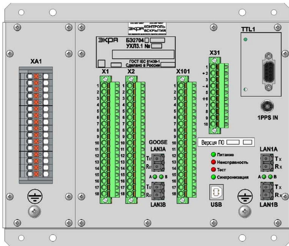
Рисунок Б.2 – Расположение элементов на лицевой плите терминалов БЭ2704 700010, 700011
