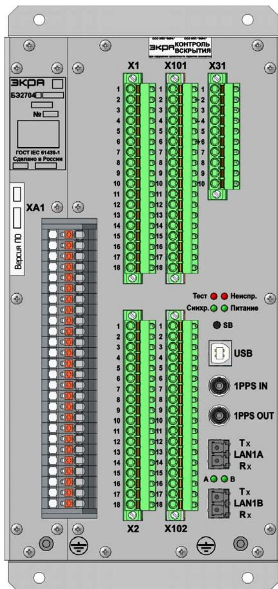
Рисунок Б.5 – Расположение элементов на лицевой плите терминала БЭ2704 750
